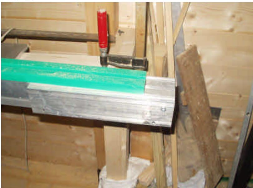
Incernierare il profilato 50x50 così preparato al tubolare 50x20 (io ho usato due piatti di alluminio fissati sul tubolare inferiore- foto 2c), la cerniera è fatta con una vite da 6mm passante.
