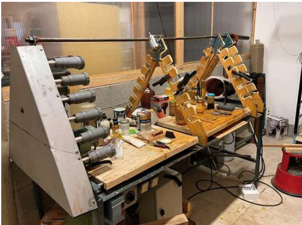
Telaio motorizzato per l'asciugatura vernici.
